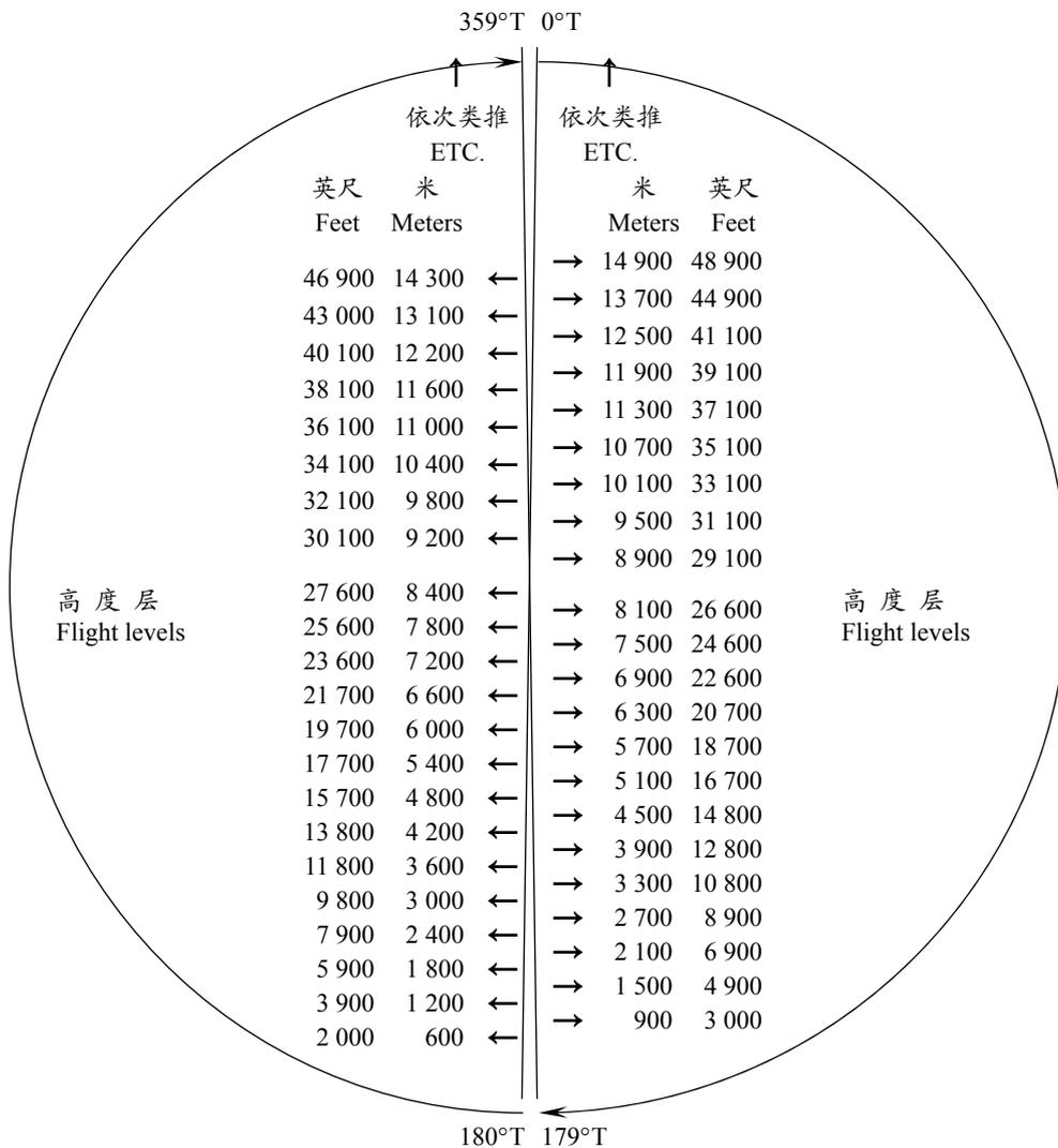
注：管制员将发布米制飞行高度层指令。航空器驾驶员应当根据中国民航飞行高度层配备标准示意图（表）来确定对应的英制飞行高度层。航空器应当飞对应的英制飞行高度层。航空器驾驶员应当知晓公英制转换带来的差异，驾驶舱仪表显示的米制高度与管制指令的米制高度不一定完全一致，但存在的差异不会超过 30 米。
